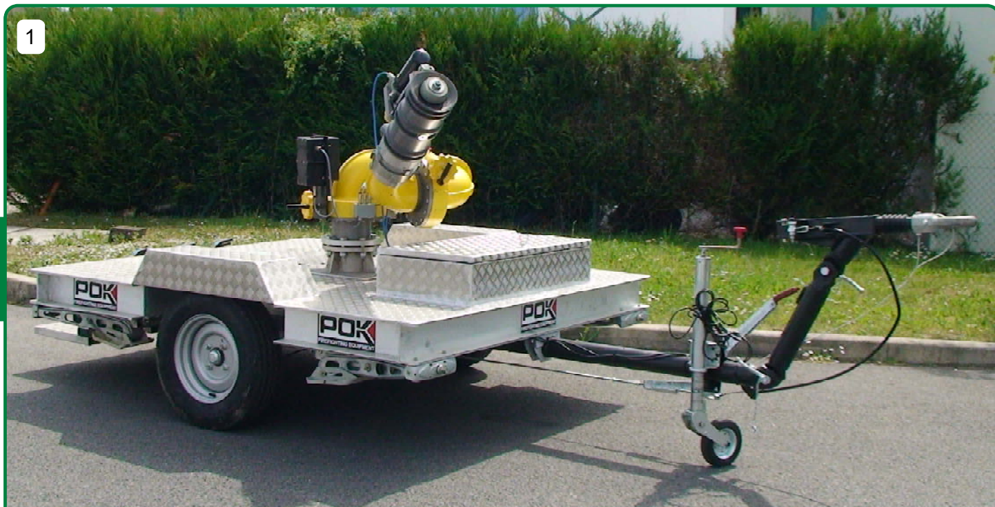
1) Ствол лафетный "DICODOPLUS DN 150" с дистанционным управлением, с диффузором (расход воды-10 000 л/мин), на мобильной платформе.
